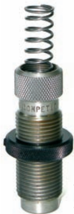
« Матрицата с поставена пружина. Ролята на пружината е да връща надолу плъзгащата се втулка, която обхваща гилзата на патрона.
