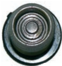
« Поглед към матрицата отгоре, при отстранен микрометричен винт. Виждат се втулката и поставящото стъбло.
