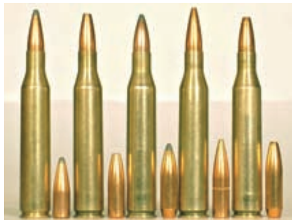
Ръчно снаряжените муниции и съответните куршуми калибър .25-06. От ляво на дясно: с куршуми от 87 grs Hornady JSP; 100 grs Speer JHP; 117 grs Sierra JSPBT; 120 grs Hornady JHP Interlock; 120 grs Sierra JHPBT.
