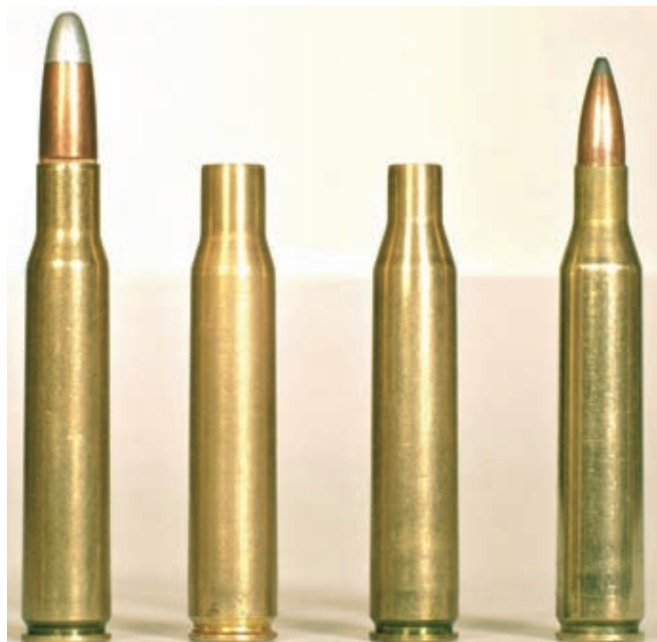
Отляво надясно: патрон и гилза калибър .30-06, гилза .25-06, получена чрез рекалибрирането на .30-06, и патрон калибър .25-06. Вижда се, че този последният има по-къса шийка от патрона „баща“ и по-бъгъло рамо, но със същия наклон.
