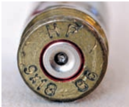
Дъното на гилзата, произведена от фирмата Hirtenberger за немската полиция. На него фигурират последните две цифри от датата на производство.
