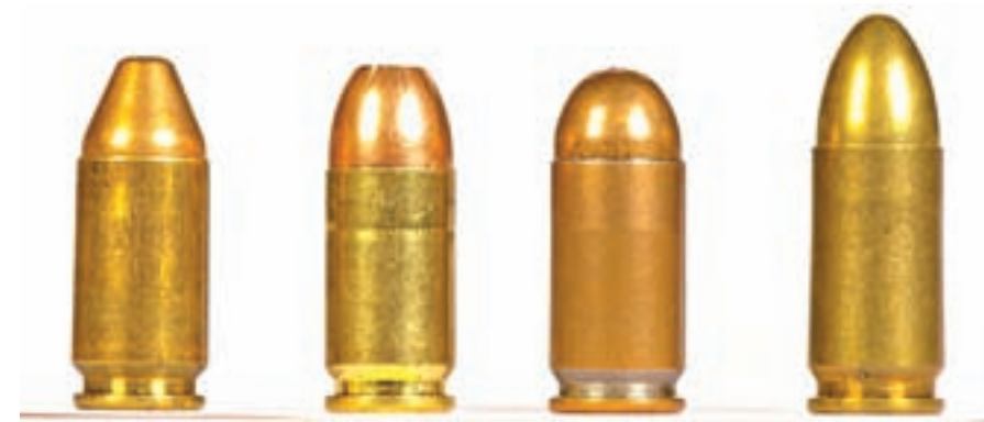
От ляво надясно: патрон 9 мм Ultra, следван от патрон 9 мм къс, 9 мм Макаров и 9 мм parabellum. Гилзата на 9 мм Ultra е mun rebated rimless, тоест диаметърът на дъното е по-малък от този на цилиндъра.
