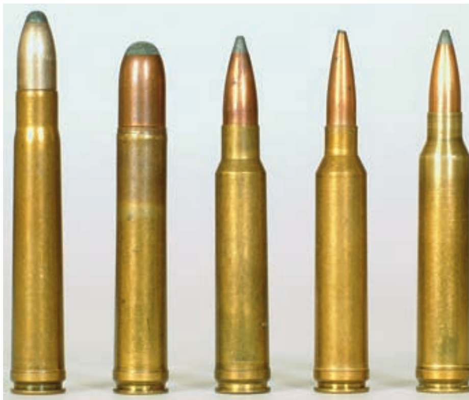
Един патрон калибър .375 Н.&Н. Magnum (първият отляво), последван от един .458 Winchester magnum, създаден през 1956 чрез скъсяване на гилзата на 2,5 инча и с един по-скоро цилиндричен профил. Следващите три патрона, всички снабдени с гилзи от .458 (и по-конкретно с тези от .375), със стесняване на шийката и създаване на рамо от 25 градуса. Става дума за .338 Winchester Magnum, който е от 1958; 7-мм Remington Magnum, който е от 1962 и за нашия .300 Winchester Magnum, който се е появил през 1963. Както .338, така и 7-милиметровият имат гилзи със същата дължина като тези на .458, т.е. 63 мм, докато при .300 Winchester Magnum е малко по-дълга, достигайки почти 66 мм.
