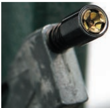
↑ Капсулт е поставен в гнездото на втулката. Ясно се виждат крачетата, които опират в дъното на капсулното гнездо.
