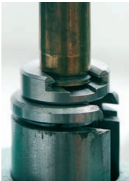
↑ Гилзата е надежно захваната от фиксатора върху ствола на пресата.
