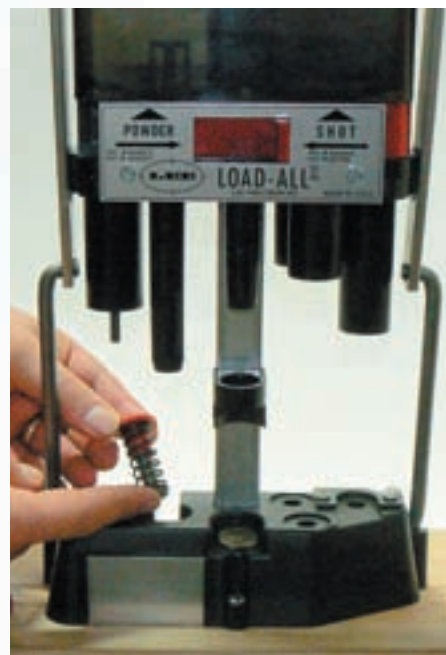
↑ Инструментът, с който се поставя новата капса към подготвената гилза.
