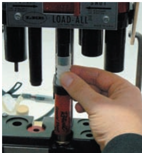
↑ Поставяне на концентратора. Притискането на барута трябва да бъде с еднаква сила за всички патрони.
