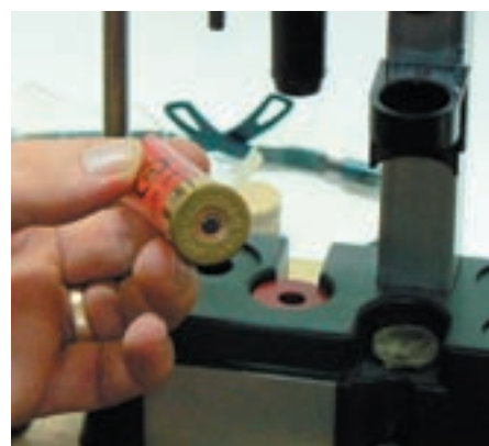
↑ Втората позиция служи едновременно за поставяне на нова капса и за изваждане на калибровъчния пръстен.
