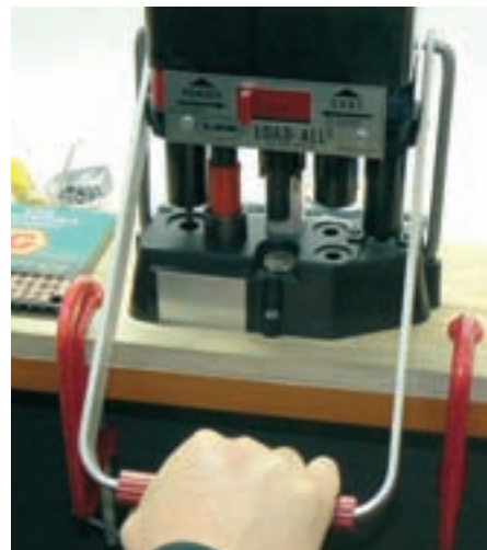
↑ Втората позиция служи едновременно за поставяне на нова капса и за изваждане на калибровъчния пръстен.
