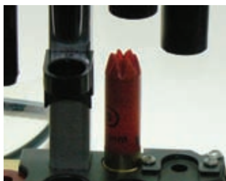
↑ Първи етап на загъване на гилзата.
