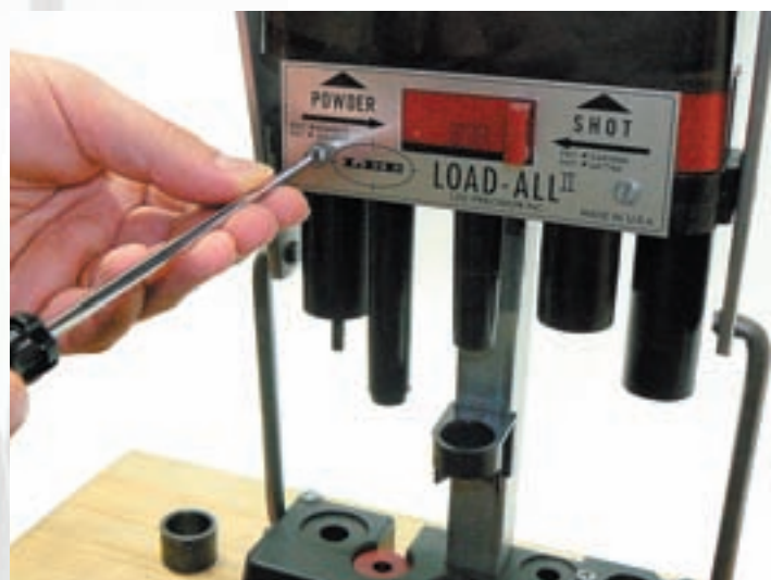
↑ Инструментът, с който се поставя новата капса към подготвената гилза.
