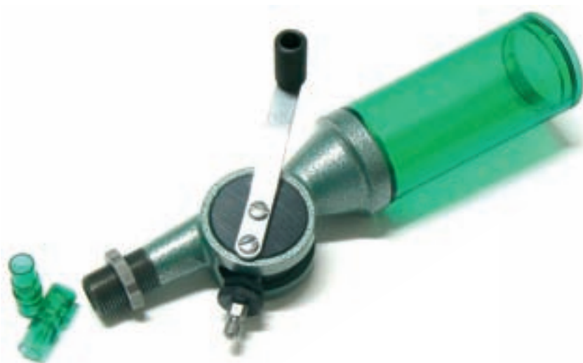
➤ Обемен дозатор за барут, произведен от RCBS. Барутът се насипва в цилиндричната му част. Необходимата доза се определя с помощта на обемния барабан в долната част на инструмента, като количеството се претегля на везна. След това чрез завъртане на дръжката предварително определеното количество барут се изсипва в гилзата. Добре е да се проверява теглото на дозата барут на всеки десет зареждания.
