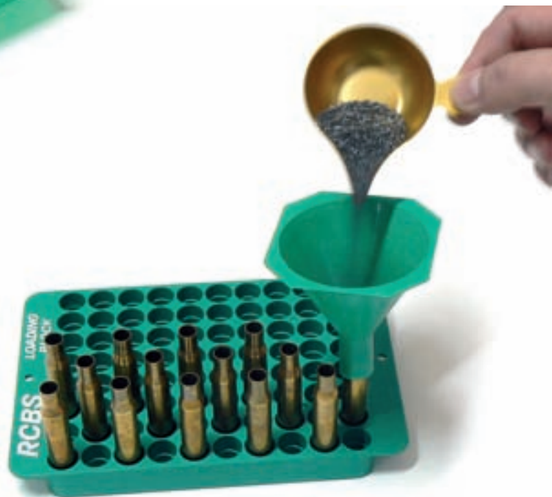
↑ Блок-поставка за гилзи и фунийка за пресипване на барута от мерителното легенче на везната в гилзите. Пресипването трябва да е внимателно и не наведнъж, за да се осигури плавно и равномерно запълване на гилзата от барутните зрънца.
