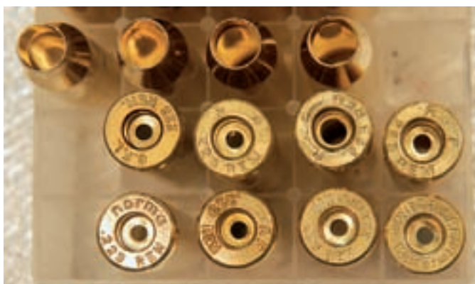
Дъната на гилзите, използвани в пробите. Веднага привлича вниманието гилзата на Remington с ОКП, разширено до 3 мм (втората отгясно на втория ред отдолу)
