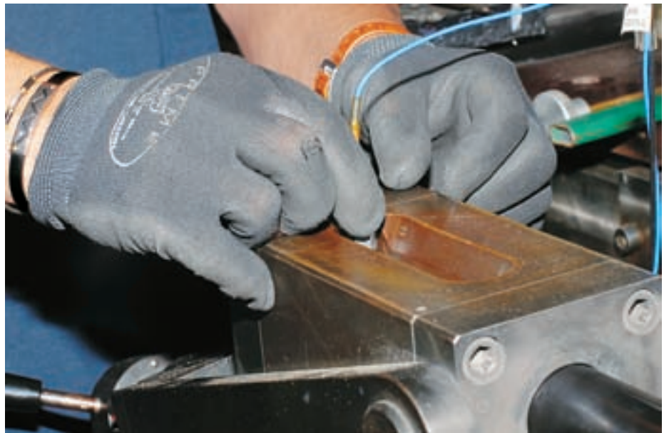
Горе: балистичната цев е готова за огън, остава само да се свърже трансдюсерът към системата за обработка на данните.
