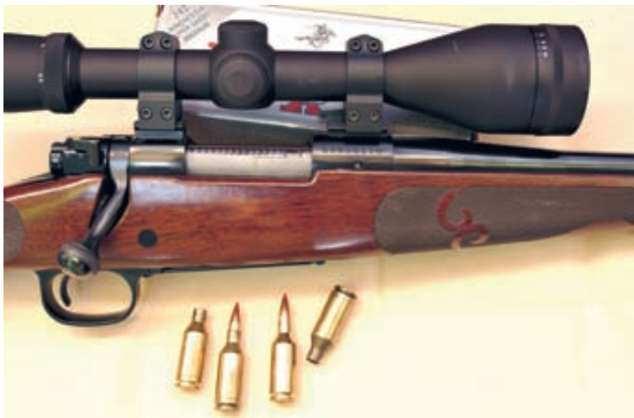
При теста със стрелба с .243 WSSM избрахме карабина Winchester Classic Featherweight с цев дълга 560 мм и оптиката Burris Fullfield II 4,5-14x42.
