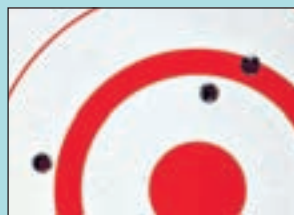
Групиране на разстояние от 200 метра със Super shadow калибър .223 WSSM, с фабрични Winchester, с куршум Ballistic Silvertip 55 grs.
