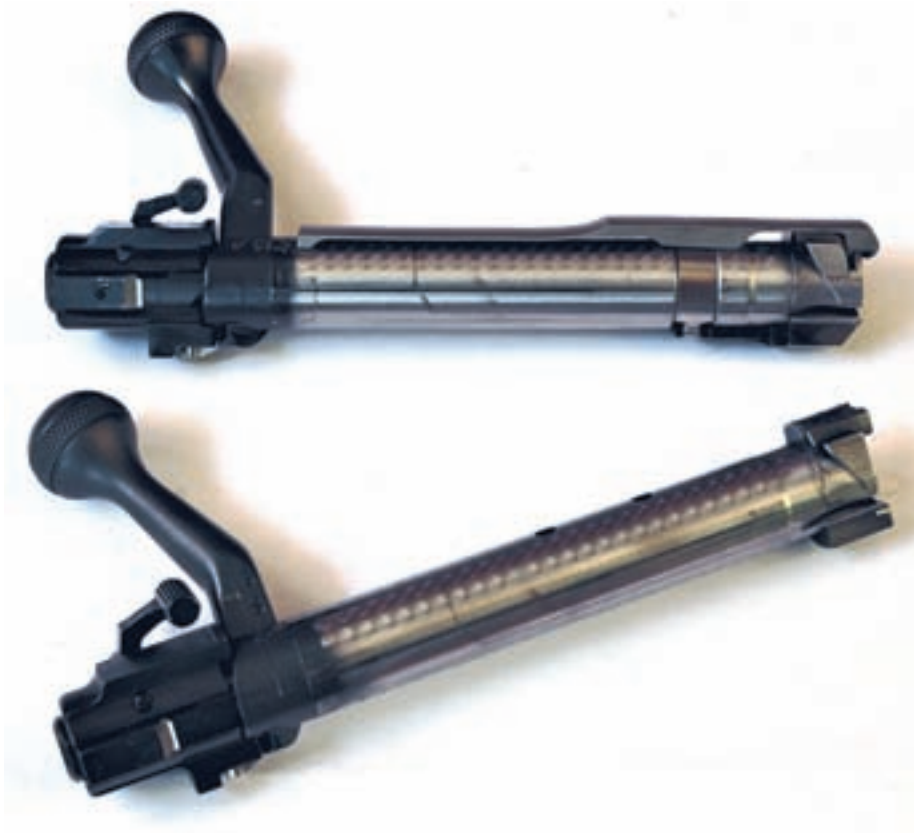
Двата затвора. Горе: на Classic Featherweight, с пластинчат екстрактор тип Mauser; долу: на Super Shadow, с екстрактор, фиксиран в заключващия упор.
