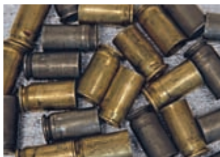
След осмото преснарядяване гилзите Focsi се удължиха дотолкова, че в някои случаи прехвърлиха максималната дължина, предвидена от CIP за патрон .45 ACP (22,81 мм). Железните гилзи обаче останаха много под тези стойности, при това без никакво нарушаване на целостта им.
