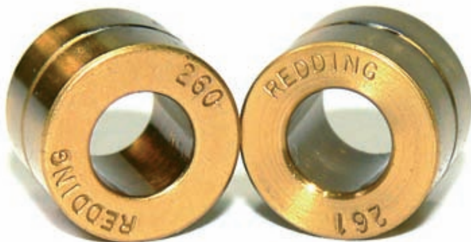
↑ Двойка бушинг пръстени за микрометричната матрица. Разликата във вътрешните им диаметри е 0,001".
